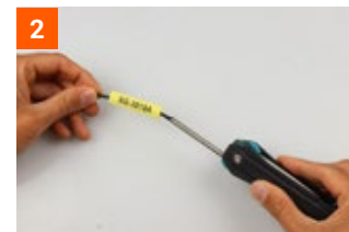
Draad in de applicator steken en sleeve over het draad schuiven
