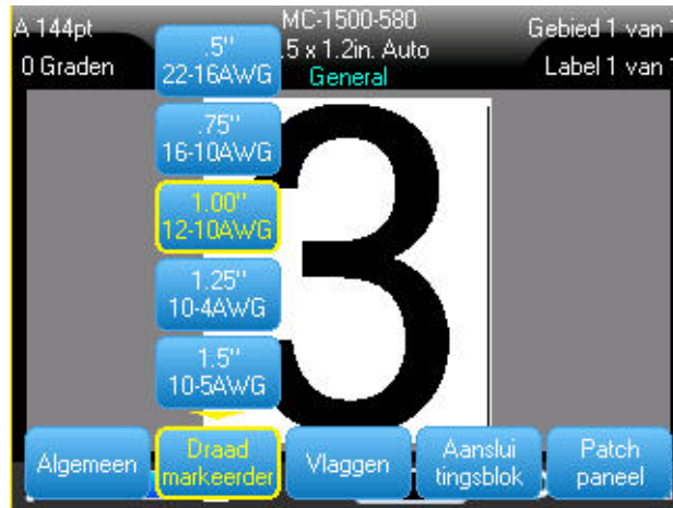
Figuur 6-2. Herhaalde tekst op een draad- of kabelmarkeringslabel
